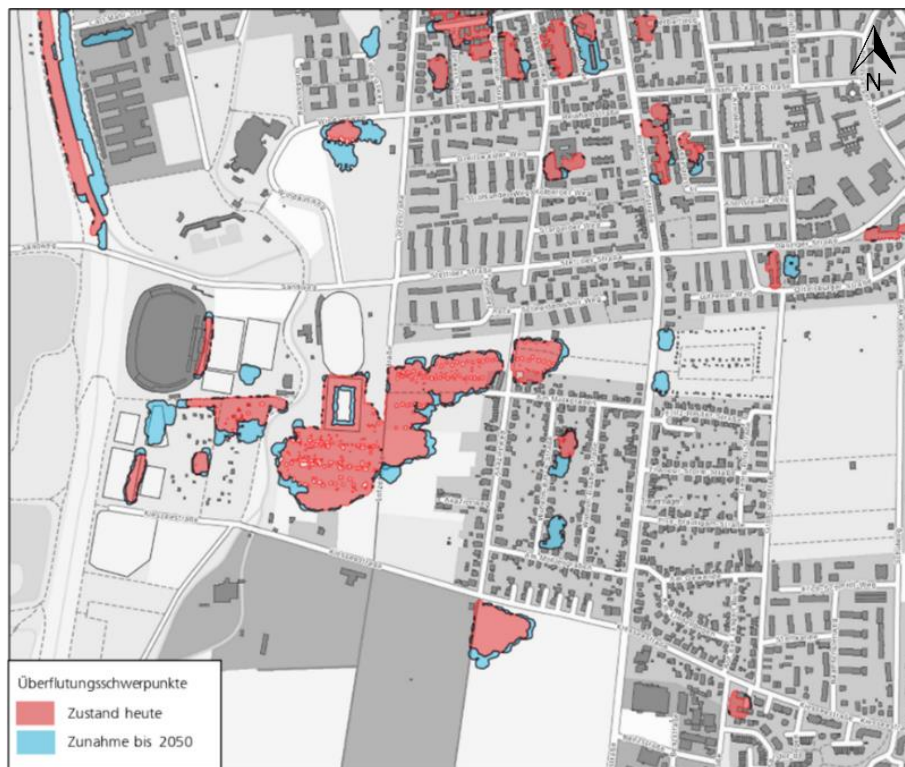
Bild 9 Exemplarische Darstellung der Überflutungsschwerpunkte (Fläche > 500 m 2 , Wassertiefe > 30 cm) (Hintergrundkarte: WebAtlasNI, „Datenlizenz Deutschland – LGLN – Version 2.0“ ( https://www.govdata.de/dl-de/zero-2-0 ))
