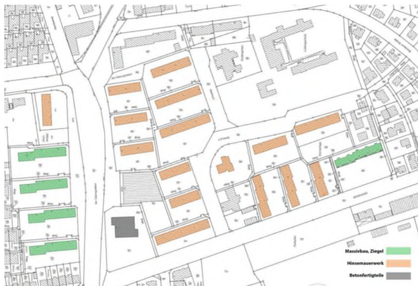
Abbildung 12: Bausubstanz der SWB-Gebäude, Quelle: Dokumentation der Auftaktveranstaltung
