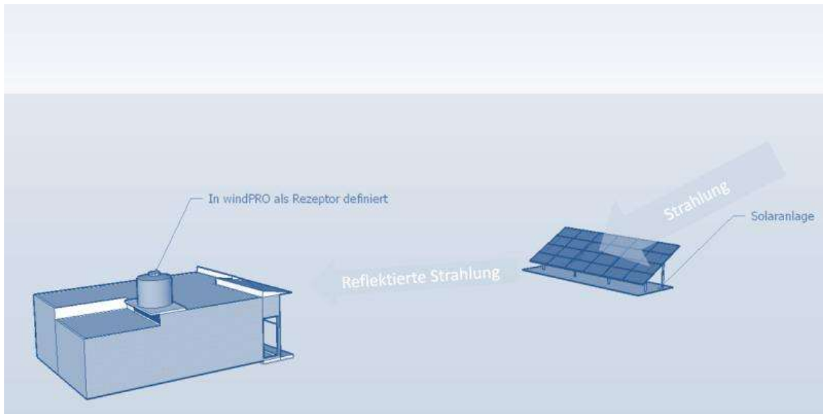
Abbildung 15 Schematischer Modellaufbau von reflektierter Strahlung am Rezeptor
