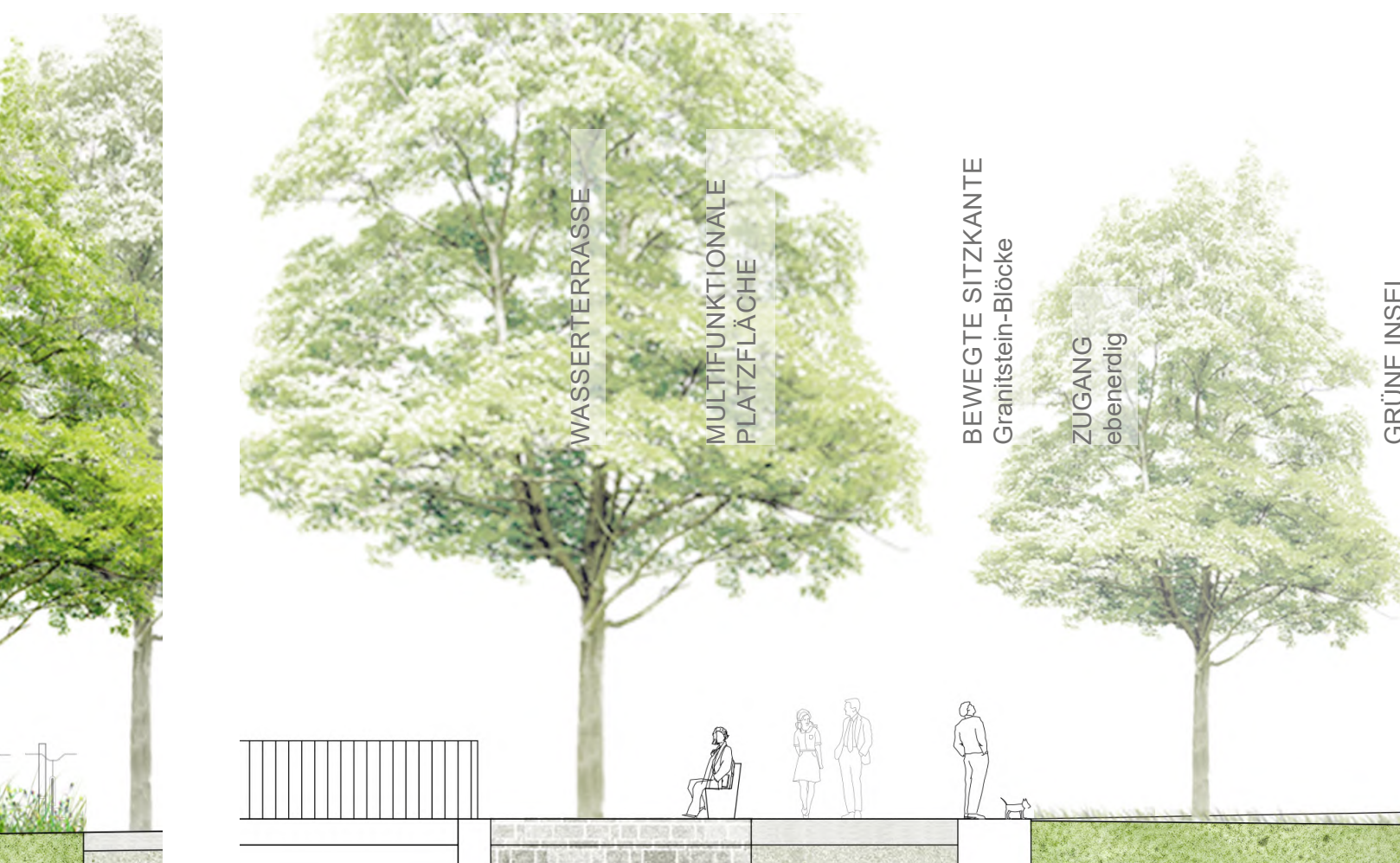
SCHNITT BB M 1: 100 - Die Insel hebt sich als Sitzkante zum Gebäude der Staatsanwaltschaft repräsentativ nach oben und senkt sich als zurückhaltende Gäste mit einer seichten Rasenböschung zum Leinekanal ab.
