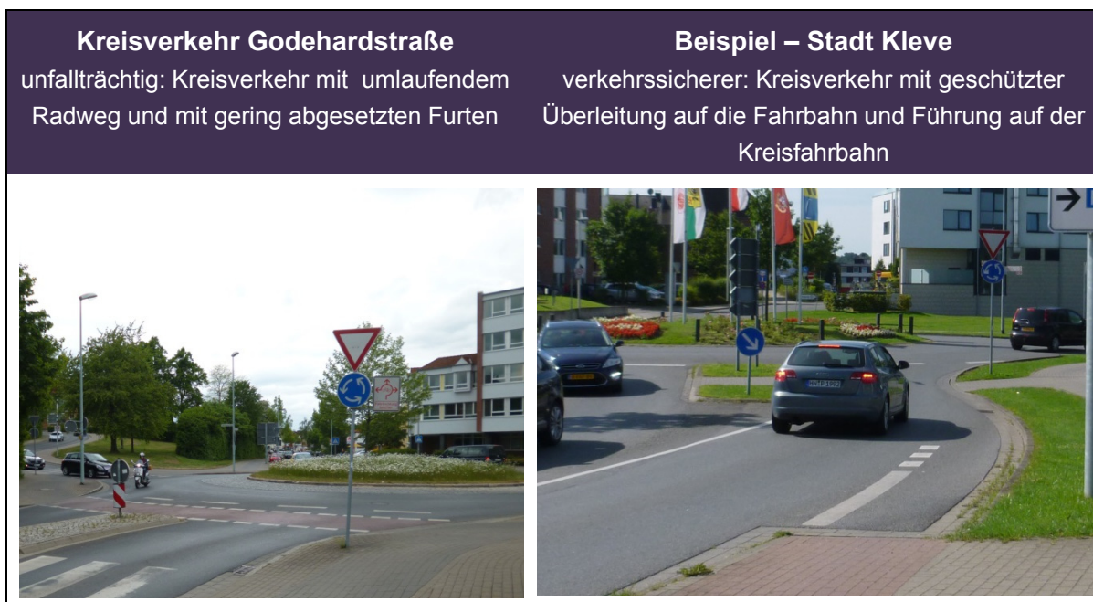
Abbildung 21: Verkehrssicherheit an Kreisverkehren – Sicherheitsvorteil der Fahrbahnführung
