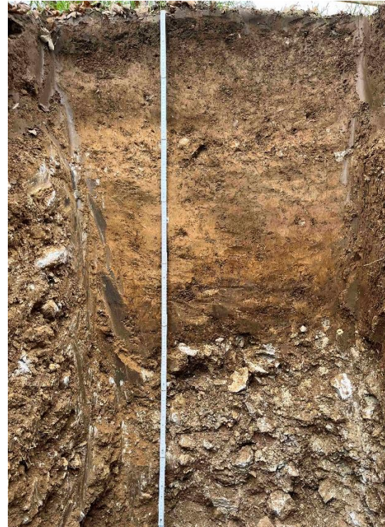
Abbildung 2: Schürfgrube S4, Ansicht Bodenprofil (Foto: WGK GmbH 2025)
