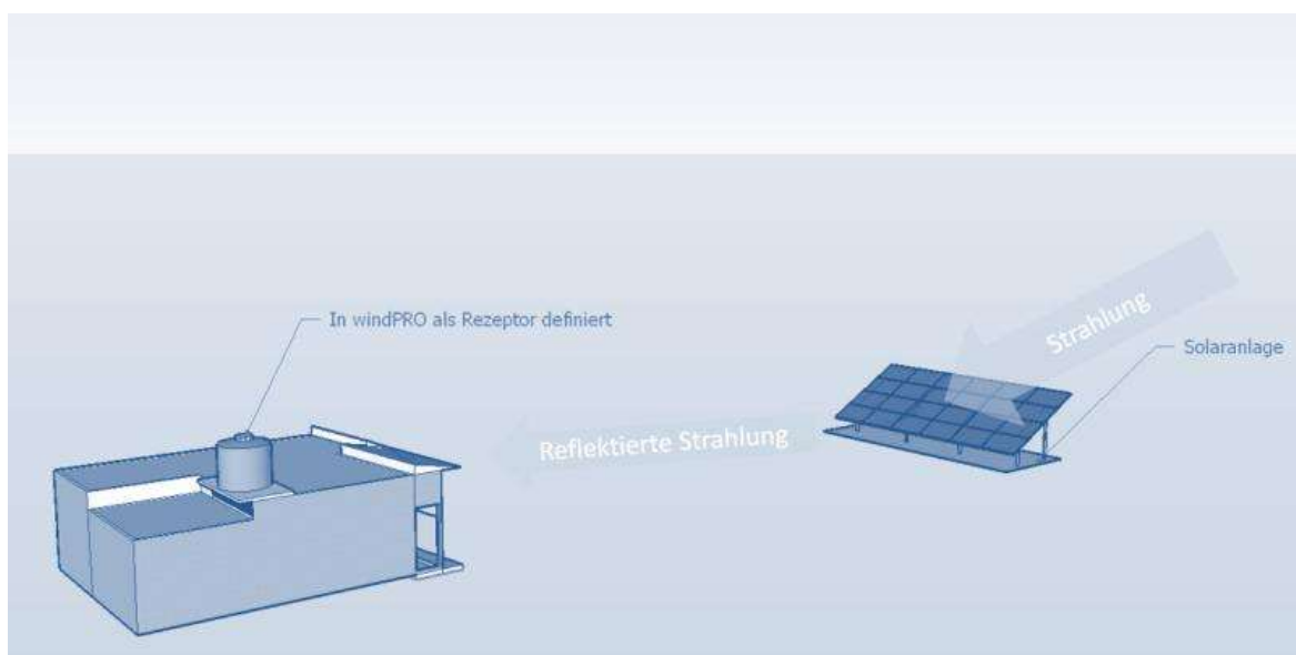
Abbildung 15 Schematischer Modell Aufbau von reflektierter Strahlung am Rezeptor
