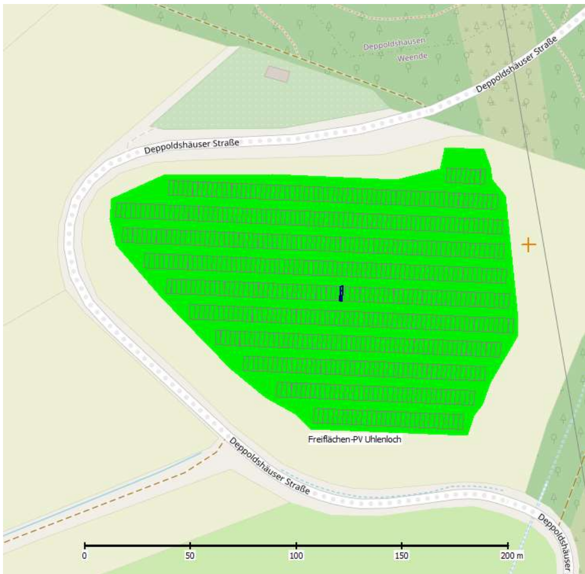
Abbildung 6: Nachbildung der PV-Flächen gemäß dem Bauantrag
