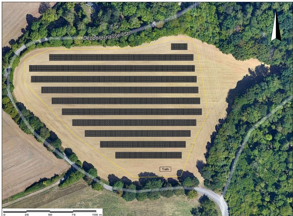
Abb. 2: Übersicht über die Projektplanfläche mit der geplanten Anordnung der PV-Anlagen. Plandarstellung der Georg-August-Universität Göttingen. Stand: 28.04.2025.
