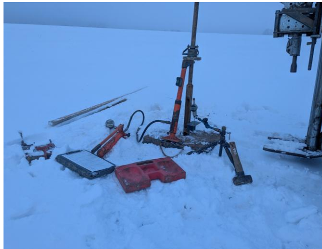
Foto 2: Durchführung des Schrägzugversuchs: Durch den Kolbenhub des orangenen Hydraulikzylinders wird eine Belastung unter Windsog in dem entsprechenden Kraftansatzwinkel simuliert. Der Hydraulikzylinder steht dabei auf einer Platte mit rauer Oberfläche und großer Auflagefläche, welche sowohl das Wegrutschen als auch die Setzung des Zylinders verhindern soll. Die Verschiebung des Pfahlkopfes wird mit einem elektrischen Wegaufnehmer (1/100 mm Messgenauigkeit) gemessen, welcher an einem unabhängigen Referenzsystem befestigt ist.
