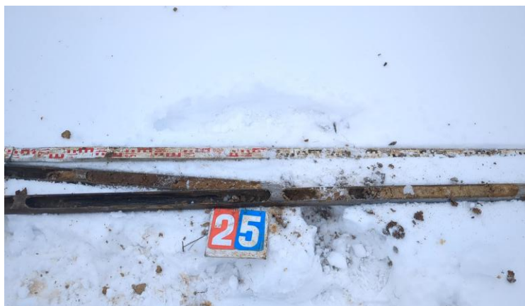
Foto 3: Typisches Bodenprofil für das Projektgebiet: Ein direkter Punktaufschluss wird hier mit einer Rammkernsondierung (Durchmesser 60 mm) realisiert. Durch den Rammvorgang wird das Bodenmaterial oft kompaktiert, daher stimmt die Zuordnung der Tiefe nicht exakt überein.
