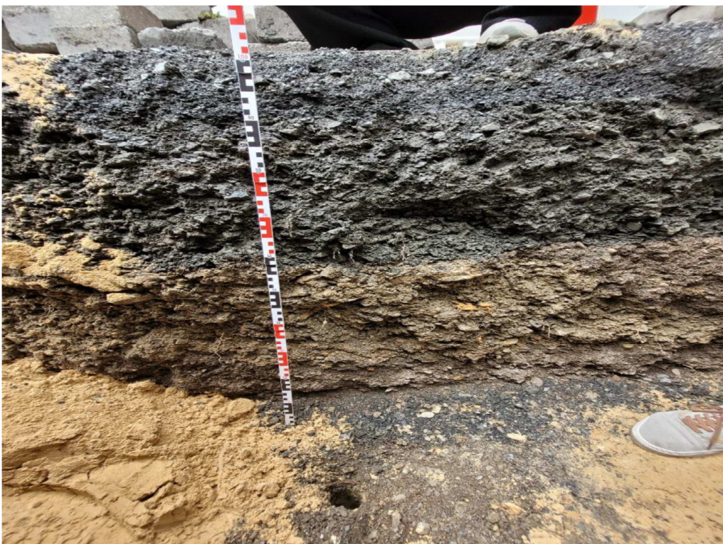
Schichtenaufbau der Grabenwand von Suchschachtung 1 (Text und Foto REHM)
